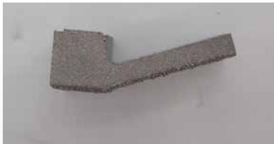
Le superfici intermedie sono caratterizzate dalla Normale dell'oggetto che punta parallelamente alla piattaforma di costruzione
