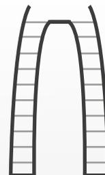
Un'ampia e improvvisa variazione della sezione trasversale favorisce la formazione di linee di ritiro a causa dell'interazione delle sollecitazioni residue.
