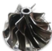
Mini reattore per test in scala costruito in LaserForm 17-4PH (A)
