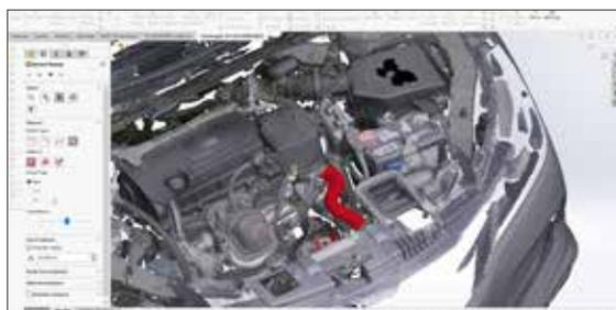
验证设计意图和准确性。检查相对于 3D 点云的模型准确性。
