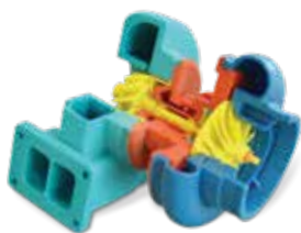
Modello concettuale di turbocompressore, con ogni componente codificato a colori per semplificarne l'identificazione
