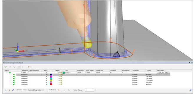
*Nahaufnahme einer Ecke, an der eine Bereinigung erfolgt. Die Bearbeitung erfolgt mit schräger 3-+2-Achsenausrichtung. Die Ausrichtung wurde über die „Guided Cleanup Auto Tilt“-Funktion automatisch vom System berechnet.*
