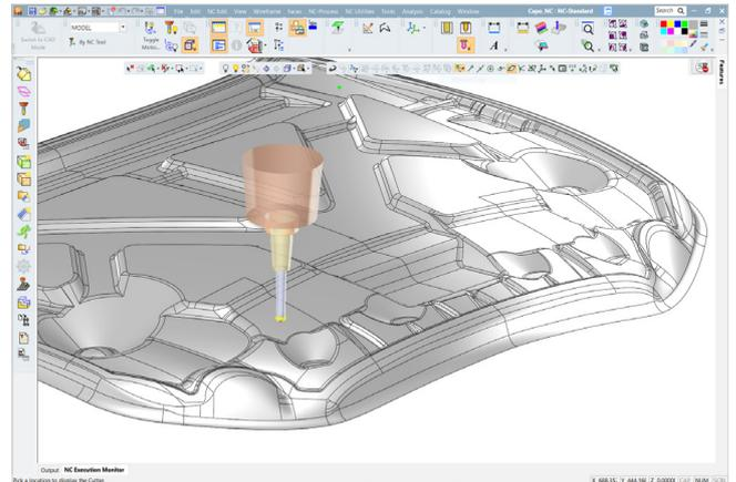
Für die Fertigung dieses Motorhaubenwerkzeugs wurde ein Kreissegmentschneider mit einem Durchmesser von 20 mm eingesetzt. Im Vergleich zu einem Kugelfräser verringerte sich die Bearbeitungszeit von 132 auf 119 Stunden, was einer Einsparung von 10 % entspricht.
