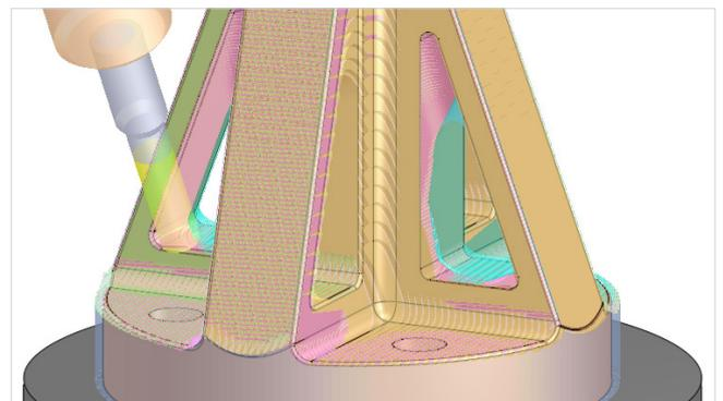
Schruppbearbeitung einer Halterung mit automatischem Schruppen 3- +2-Achs-Bearbeitung. Die Einfärbung des Modells gibt Aufschluss über die Ausrichtung. Die Richtungen werden automatisch vom System vorgegeben.
