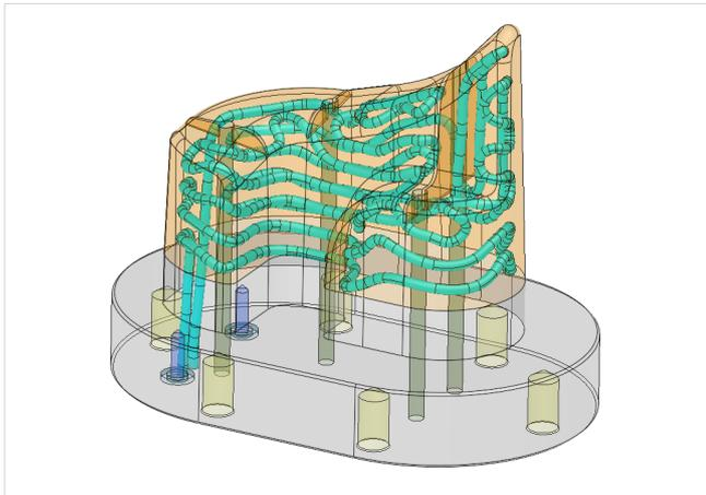
Konturnahe Kühlkanäle automatisch generieren
