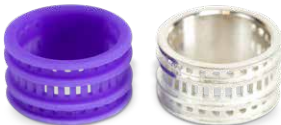
Anello costruito con Visijet M2 CAST e fuso in argento
